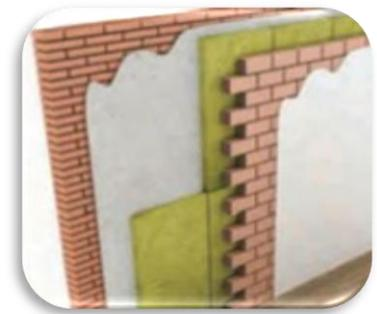
L'isolation thermique intérieure consiste à poser un isolant sur la face intérieure du mur puis de le recouvrir par un parement. De manière générale, Le complexe isolant est composé d'un système de fixation, d'un isolant, d'un parement et d'une finition. La mise en œuvre dépend des caractéristiques du mur et du type d'isolant choisi. En Belgique, suite à de nombreux désordres constatés, l'isolation par l'intérieur n'est prescrite que quand l'aspect extérieur de la façade ne peut être modifié.
